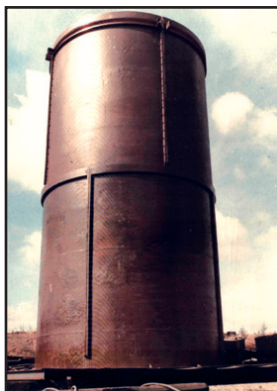
Две царги диаметром 4,5 м из слоистых пластиков в сборе
