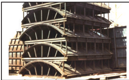
Пресс-формы для изготовления транспортабельных элементов царг диаметром 4,5 м из слоистых пластиков на основе фаолита
