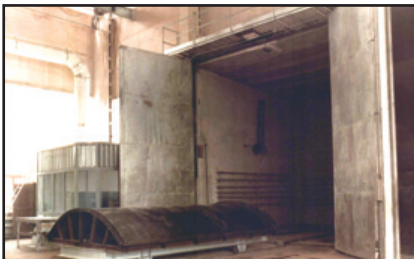
Полимеризационная камера для отверждения изделий из слоистых пластиков на основе фаолита (Асбестовский завод металлоконструкций)
